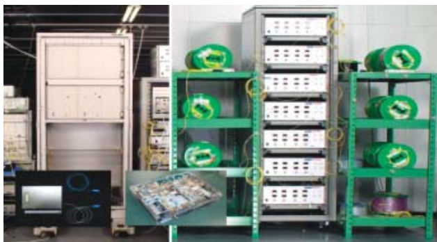
40Gbps送受信装置と光中継伝送試験系
