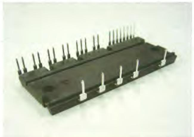
車載用DIP-IPMの外観
