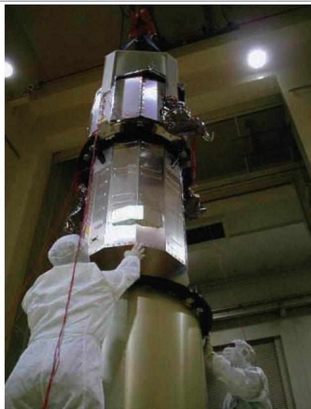
SOLAR - B衛星の熱試験モデル(左)と可視光望遠鏡(OTA)の構造試験モデル(右)
