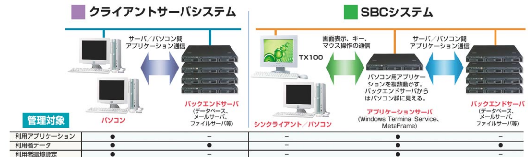
SBCシステムによる端末運用管理負担の軽減 管理対象をサーバに集中
