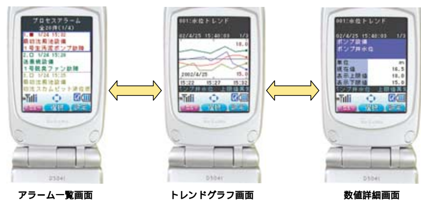
アラーム一覧画面 トレンドグラフ画面 数値詳細画面 プラント監視画面例
