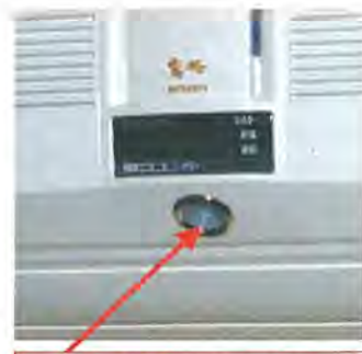
100°の広範囲で床温度を 測定する“床温度センサー”
