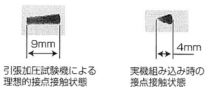
図6. 感圧紙による主接点接触状態調査
