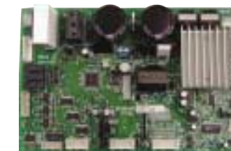
インバータ制御基板
