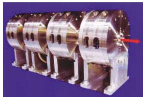
半導体レーザー励起固体レーザー
