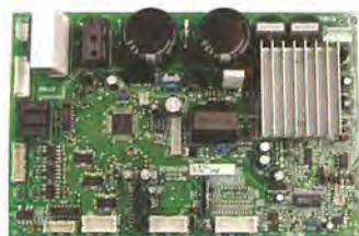
インバータ制御基板
