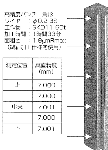
図5. HL回路による加工例
