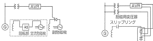
(a) ブラシレス励磁方式 (b) 均一ブリッジ型サイリスタ励磁方式
