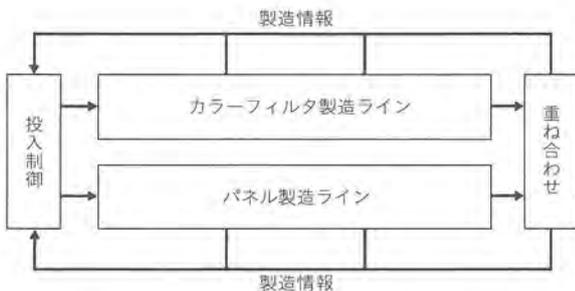
▲パネル工程フィードバック制御イメージ
