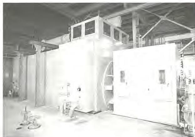
▲250MVA空気冷却タービン発電機
