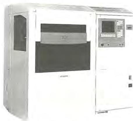
▲超高精度ワイヤ放電加工機“PX05”の外観
