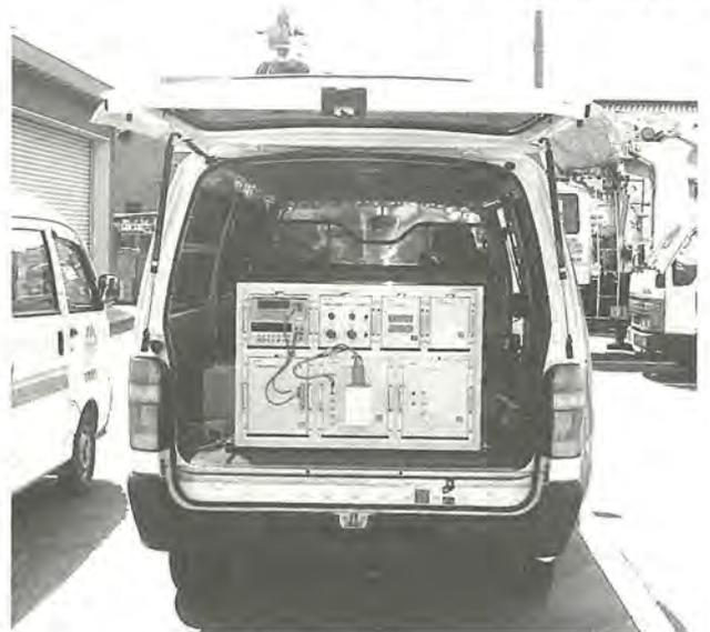
象とした各種の点検設備診断及び情報の一次診断装置、並びに通信装置を車に搭載した移動型の診断システム(移動診断車)を開発した。
