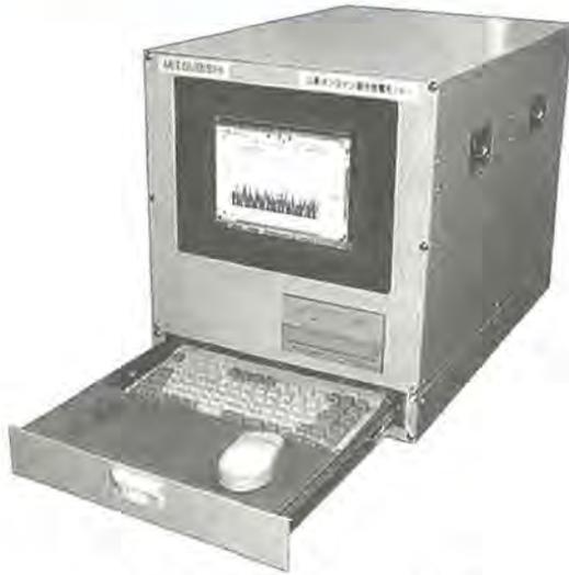
▲発電機の部分放電モニタ装置
