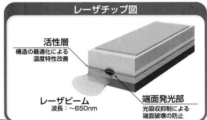
DVD-RAM用レーザには、650nm帯の短波長領域で、高温・高出力・高信頼度動作が求められる。これを実現するために活性層構造の最適化、発光部端面の強化が必要になる。
