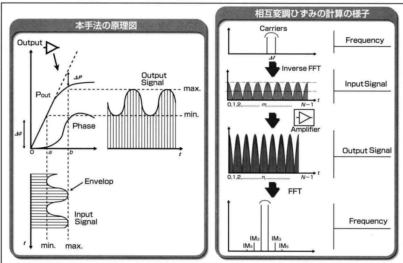
マイクロ波増幅器のひずみ特性計算法の原理図と相互変調ひずみ特性の計算の様子
