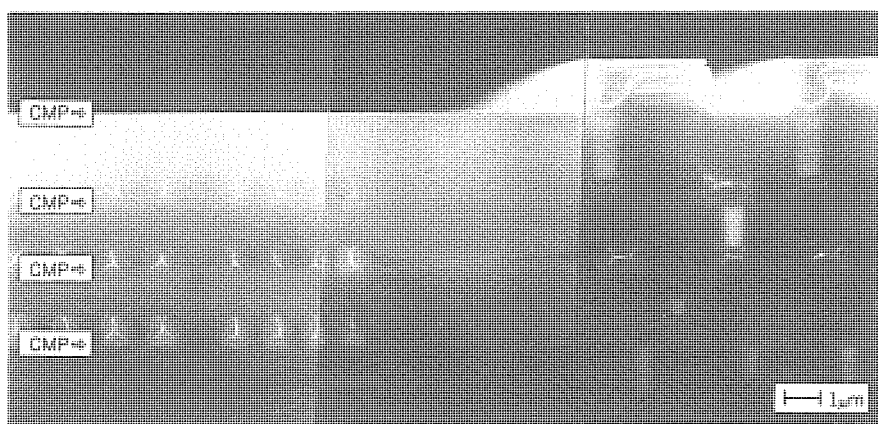
図5. CMP法による層間絶縁膜の平坦化
