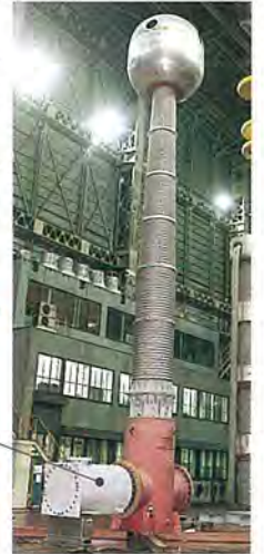
500kV高抵抗避雷器の構造と耐電圧試験状況
