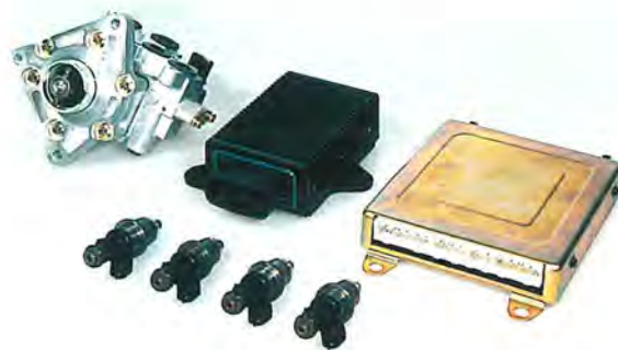
後列左から、高圧燃料ポンプ、インジェクタドライバ、エンジン制御装置を、前列は高圧インジェクタを示す。
