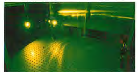
Qスイッチ固体レーザーの波長変換によって発生させたグリーン光伝搬の様子
