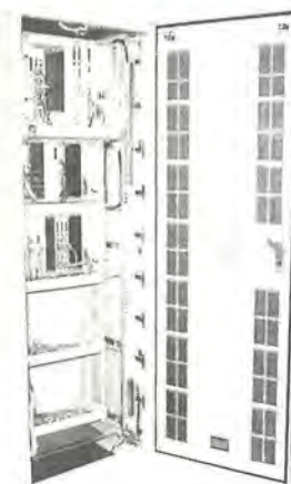
配電線自動化システムテレコン親局装置
