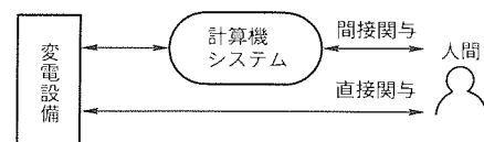
図1. 運用員と変電設備の接面
