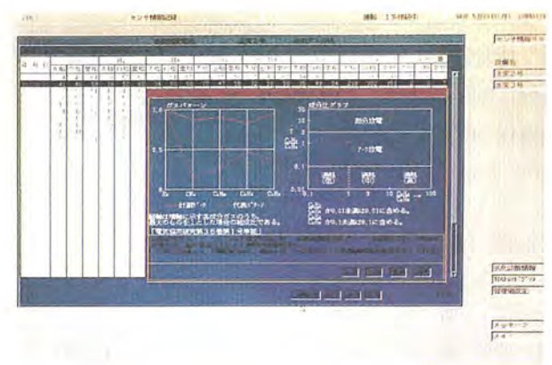
図13. 変圧器油中ガス分析監視の試験時画面例
