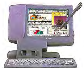
ドッキングステーションに AMITY SPとキーボードを接続
