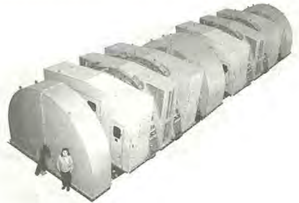
51,300kW直流発電機
