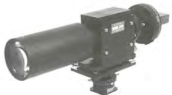
レーザー同位体分離用真空仕様温度補償型波面センサ
