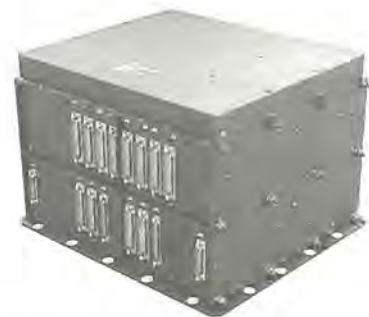
誘導制御計算機エンジニアリングモデル
