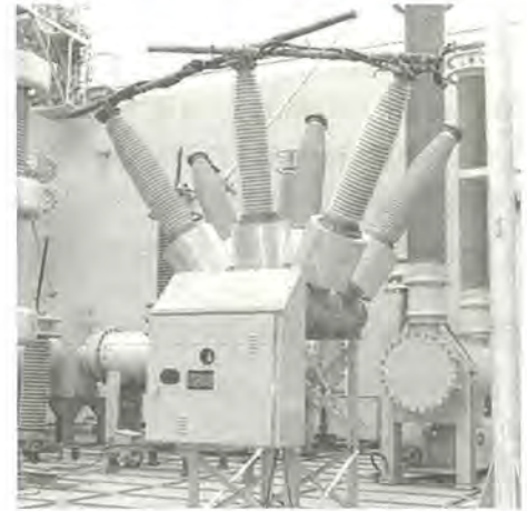
新形ばね操作形ガス遮断器(遮断試験)
