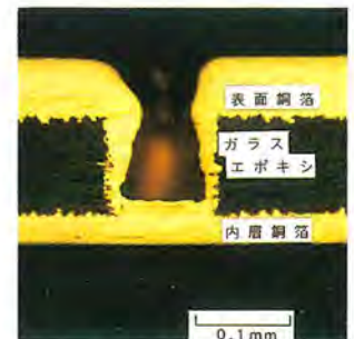
ガラスエポキシ基板に形成したスルーホール(左)とブラインドホール断面(右)
