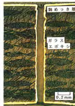
ガラスエポキシ基板に形成したスルーホール(左)とブラインドホール断面(右)
