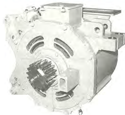
565kW 誘導主電動機
