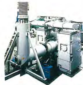
変換用変圧器絶縁検証モデル
