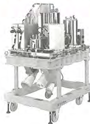
航空機搭載用マイクロ波放射計 (18/23/36/89GHz 帯用)
