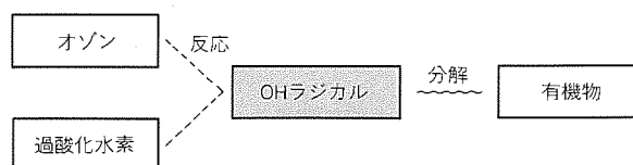
図 5. 過酸化水素添加オゾン処理法の原理
