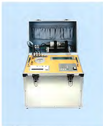
ポータブル油中ガス分析装置 PGA-200
