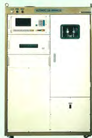
オンライン式油中ガス監視装置 TCG-6C
