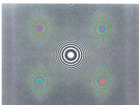
図3. 第一世代アルゴリズムによる処理画像 (ゾーンプレートチャート(CZP))
