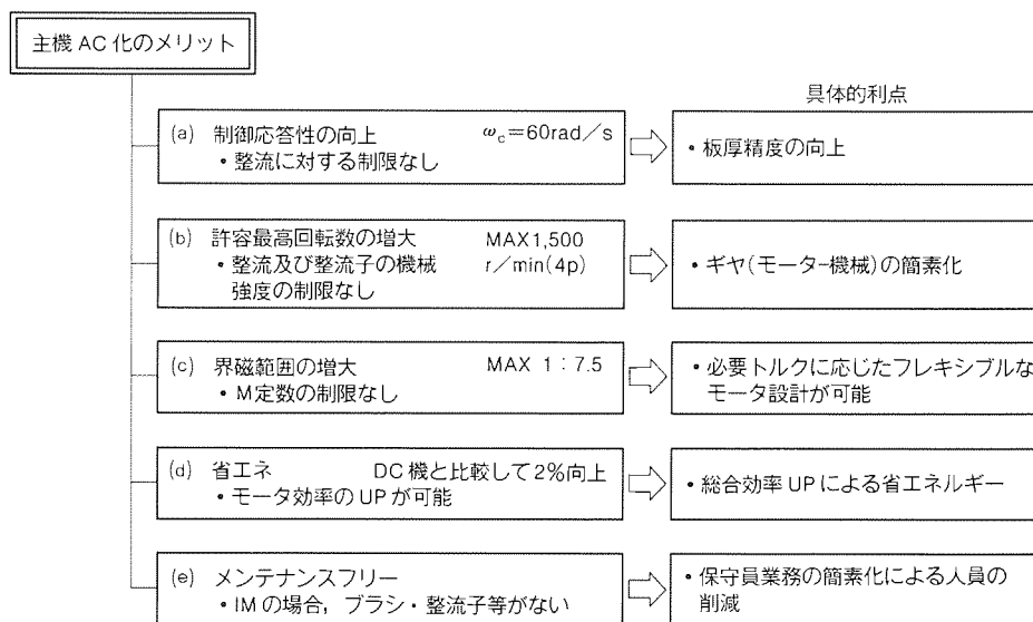
図1. 主機電動機の交流化メリット
