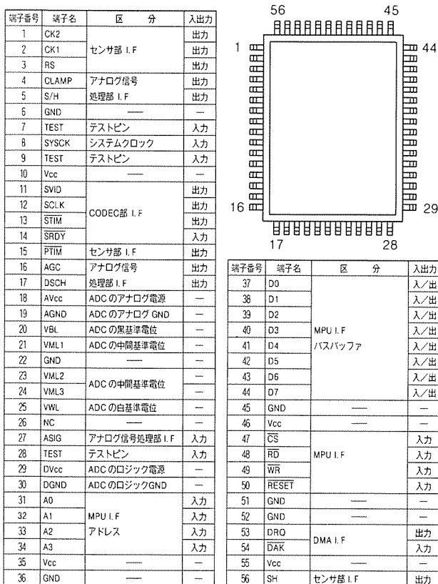
図 3. M66332FP のピン接続図
