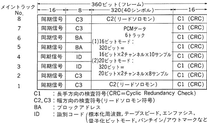
図3. 2チャンネルPDフォーマットの信号構成
