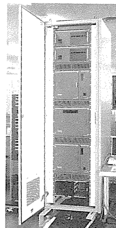
図 3. CPUユニット実装盤の外観 (各ユニットは幅480mmのJIS標準ラック, 盤の高さは2,300mm)
