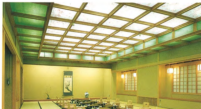
2. 白水館「薩摩屋敷」（指宿市） 白水館「薩摩屋敷」は、主に料亭として使用され、その照明は、木肌を生かした光天井により優雅さと格式高さを創りだしている。パネル部分には手書きによる花の絵（桜、あじさい、紅葉など）が全体にちりばめられ季節感を演出している。また、光源には、演色性のよいルビカエースを使用し、絵をあでやかにするとともに料理を忠実に照明している。
