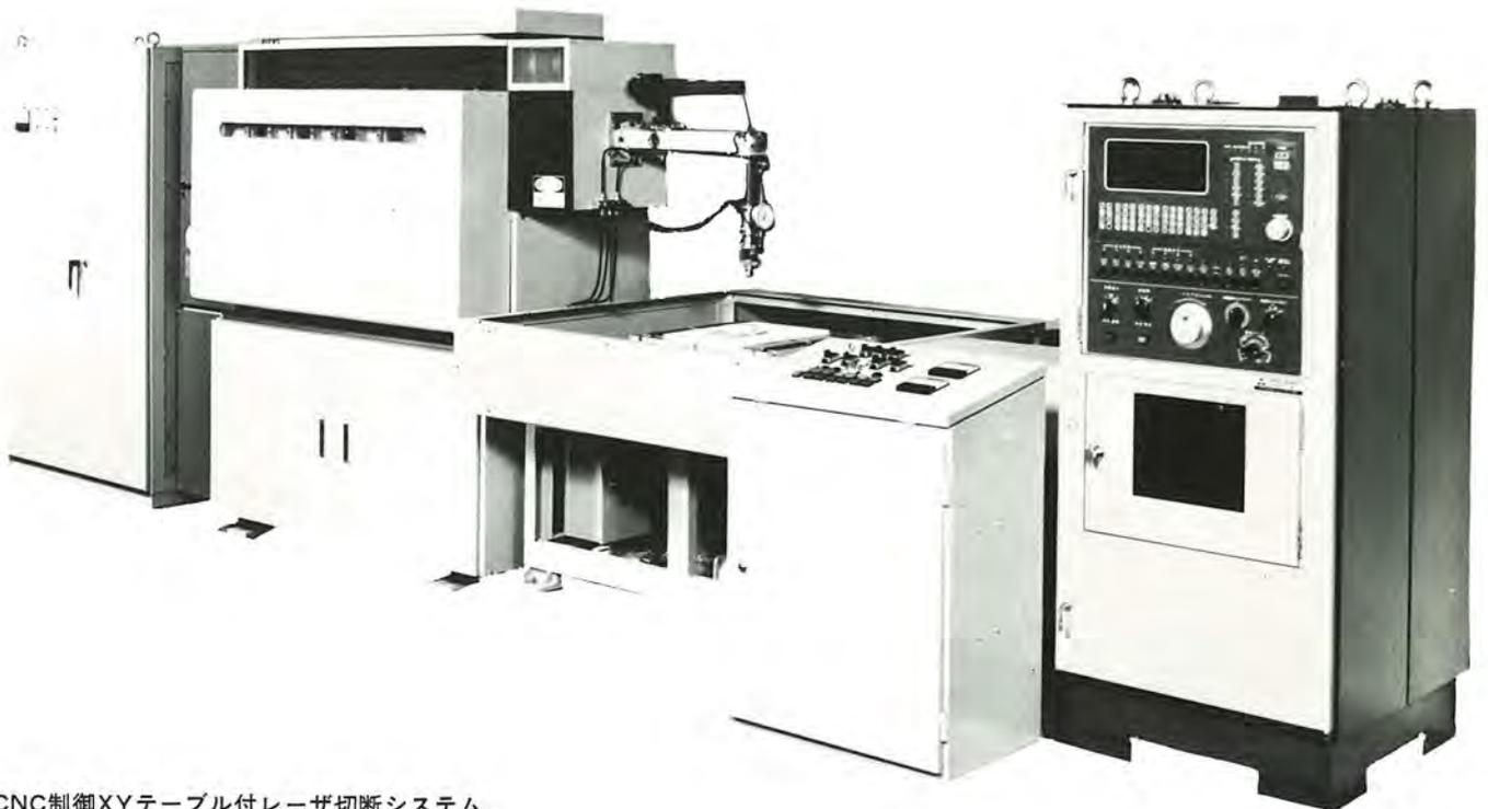
CNC制御XYテーブル付レーザー切断システム
