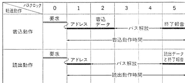
図 3. スプリットサイクル方式のメモリバス動作
