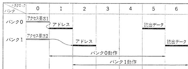
図 5. 2 ウェイ・インタリーブ時のバンクの動作例
