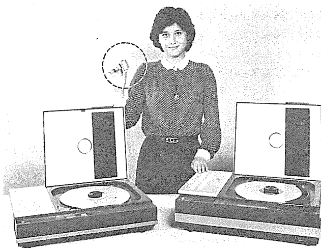
図 12. ビデオディスクプレーヤー(左)と PCM オーディオディスクプレーヤー(右) 点線円内は超小形半導体レーザーピックアップ
