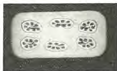
\text{Nb}_3\text{Sn} 安定化超電導線 ( 1.6 \times 3.2 \text{ mm} 平角)
