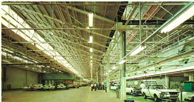
1. 三菱自動車工業(株)名古屋製作所岡崎工場 (愛知) 延べ70,000㎡に及ぶこの新工場は、三菱自動車が誇る「ギャラン」「セレステ」などの量産工場として完成した新鋭工場である。照明は全般照明用に工場照明用器具「パワールミ」約2,000台が取付けられた。「パワールミ」はFLR110H×2灯用反射かさ付き器具で、効率のよい照明・快適環境づくり・取付け・保守の省力化などの特長をもつ本格的工場照明用器具である。また組立ラインの局部照明用にはFLR40S×2灯反射かさ付き器具がライン両側上方に連続して取付けてある。
