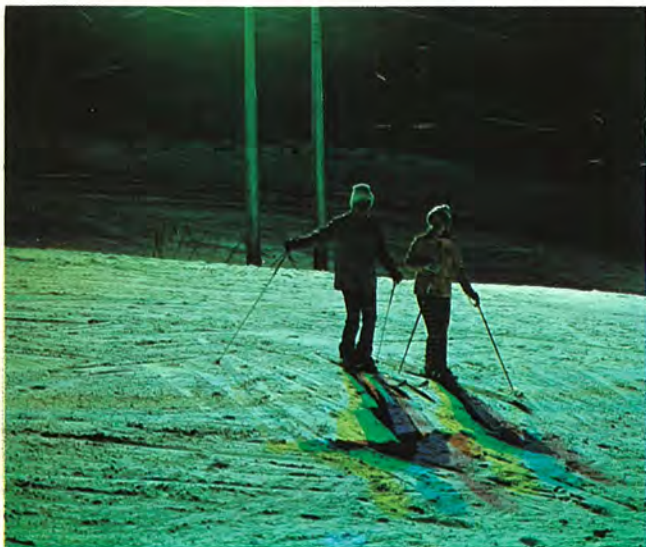
3. 朝里ホワイトバレースキー場 (小樽) 「カラーシャドー照明システム」によるスキー場照明である。ゲレンデ上のスキーヤーの色彩が千変万化するカラフルな新しい照明が大へん好評を博した。延長500mのゲレンデのほぼ中央、傾斜のゆるやかな約70m×50mの部分にこの照明が使用された。高さ15mのバンザーマスト上にカラーシャドー専用投光器を3組計9台設置、照度は前後のゲレンデの一般照明との関連から平均20lxになっている。
