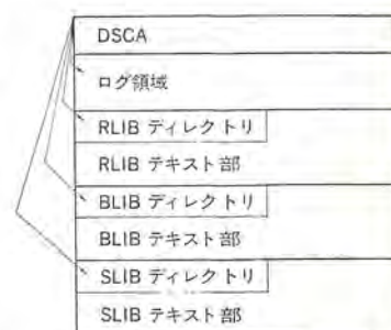
図 4. システム定住ファイル (④SYSF) の構造
