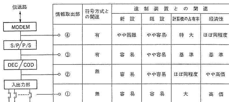
図 2. 情報伝送装置と計算機との インタフェース
