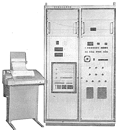
図 7. 変圧器低電圧試験装置
