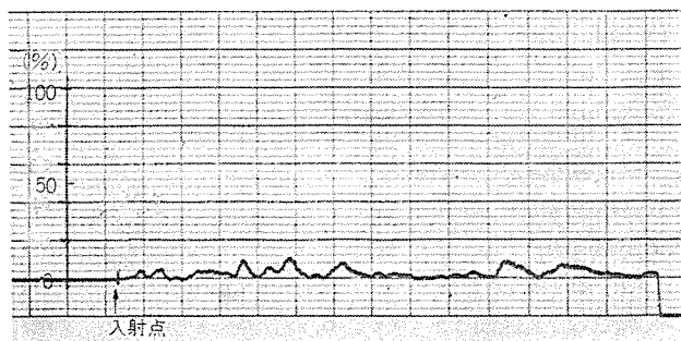
図 9. ロールにおける異常部の探傷図形
