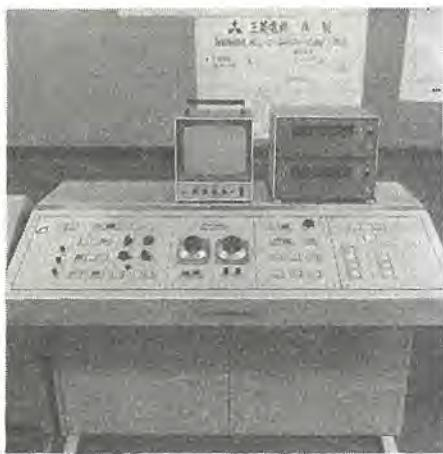
図 13. 自動製図機の操作パネルの一例
