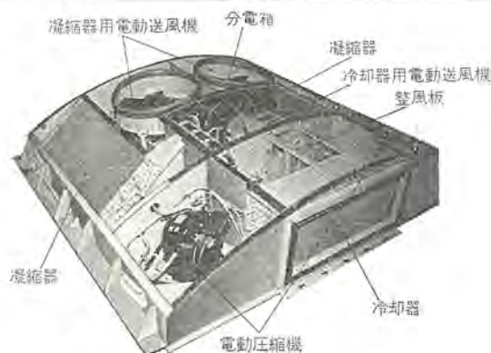
図 3. AU 76 形ユニットクーラの内部構造 Type AU 76 unit cooler.
