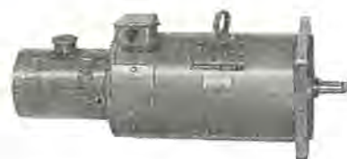
図 16. ミルスモータ (750 W) の外観 モータ反負荷側にギヤボックス(レゾルバ、タコジェネレータが内蔵)が付属している。
