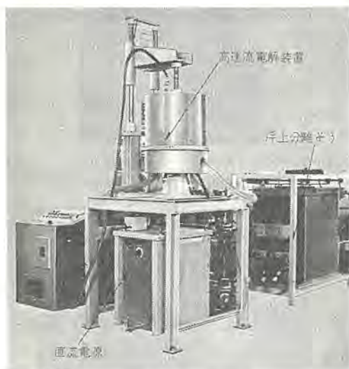
図 13. 微小間げき高速流方式 電解処理装置 (可搬形 2 m³/h, 300 A)
