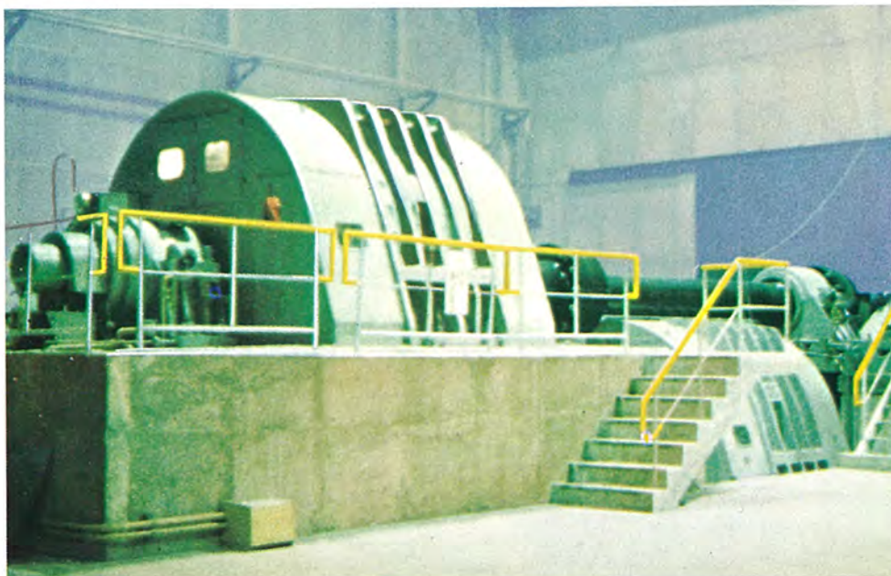
韓国POSCO製鉄所納め分塊ミル用主電動機(双子駆動ボトムフォワード配置式)(本文の 3-1.2 参照)
