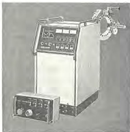
図 54. MEL-O-MATIC TIG チューブ自動溶接機 MEL-O-MATIC TIG tube automatic all position arc welder.
