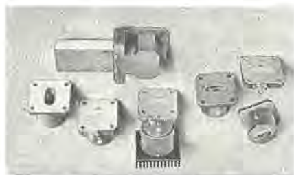
図 31. 各種ガン発振器とレーダセンサ Several types of gunn oscillators and sensors.
