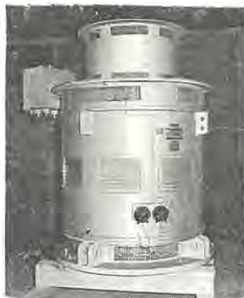
図 18. バウスラスト用誘導電動機 1,125 kW 10 極 Induction motor for Bow thruster 1,125 kW 10 poles.
