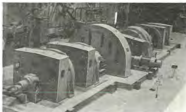
図 13. 韓国 POSCO 製鉄所納め分塊ミル電源 Ilgner M-G Set IM 6,500 kW 11,000 V 60 Hz 12 P 590 rpm DCG 4-1850 kW 750 V.
