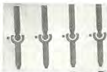
図 33. ビームリード型 PIN ダイ オード Beam-lead type PIN diodes.
