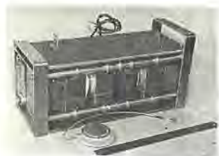
図 30. FR 600 AX-50 の素子 外観とスチック外観 FR 600 AX-50 and 2S stack.
