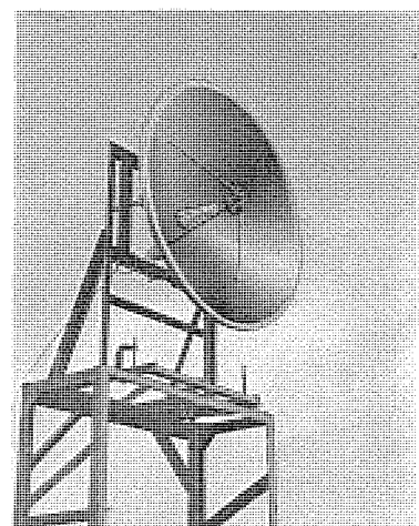
図 4.4 20 GHz 地上中継回線用カセグレンアンテナ A Cassegrain antenna in the 20 GHz band for terrestrial relay links.
