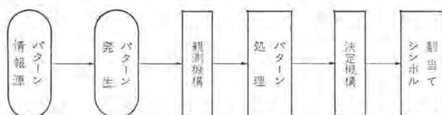
図 1.1 パターン識別の通信路モデル Model of communication passage for pattern classification.
