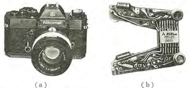
図 1.2 一眼レフ用 IC 採用カメラ(a)とその IC 実装基板(b) (a) Single lens reflex camera using a monolithic IC. (b) An applied PCB of the IC.
