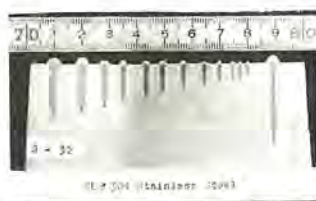
図 4.7 溶接速度の影響（ステンレス鋼 SUS 304） 290～3,120 m/min
