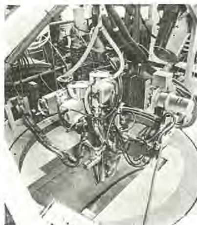
図 3.4 溶接ヘッド Welding head.
