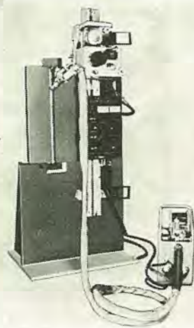
図 2.6 立向自動溶接装置 OSCON-VB 溶接装置の外観 Exterior view of OSCON-VB machine.
