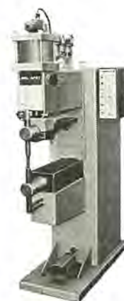
図 2.1 定置式単相スポット溶接機 Single phase AC spot welder.
