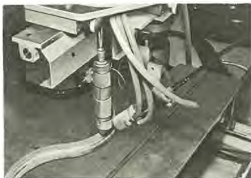
図 4.10 ならい自動溶接機 Example of automatic welder with optical distance sensor.
