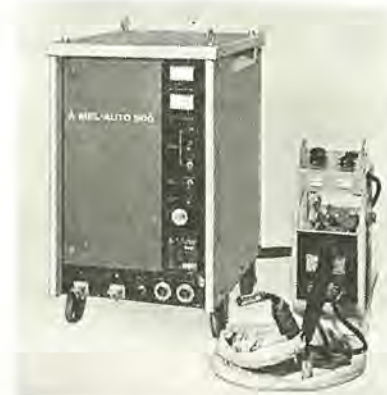
図 2.1 SA-300 形半自動溶接機 Type SA-300 semi-automatic arc welder
