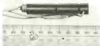
図 6.3 光学式こう配検出器の外観 Appearance of optical slope sensor.
