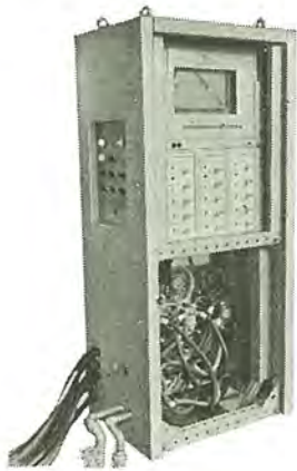
図 2.1 はん用マルチ溶接機用制御装置 Control panel for multiple spot welder.
