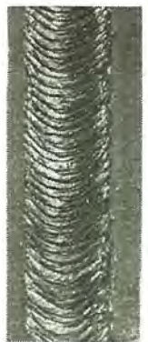
図 2.7 立向自動溶接装置 OSCON-VB 溶接法による ビード外観 (一例) Bead of vertical up welding with OSCON-VB process.
