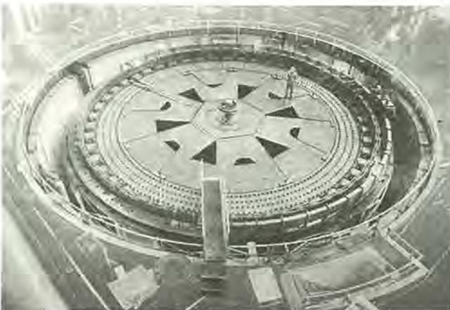
図 2.4 工場組立中のシリキット発電所向け158.5/132 MVA水車発電機
