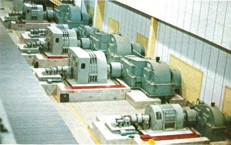
新日鉄君津製鉄所納め連続大形形鋼設備中間圧延機 駆動電動機群
