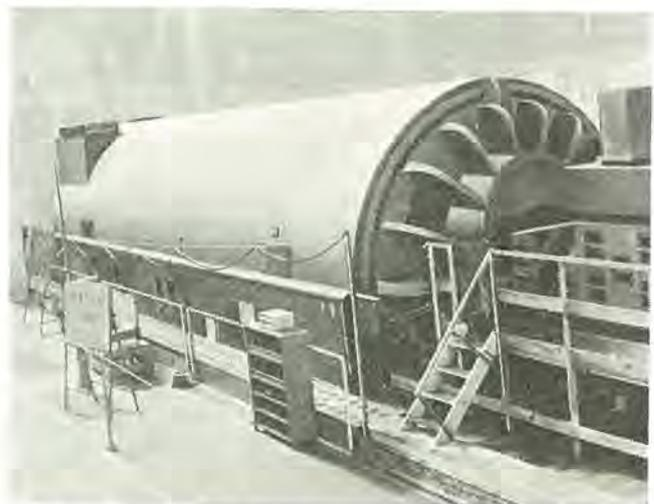
図 2.1 関西電力高浜発電所1号機 920 MVA 1,800 rpm 内部冷却タービン発電機
