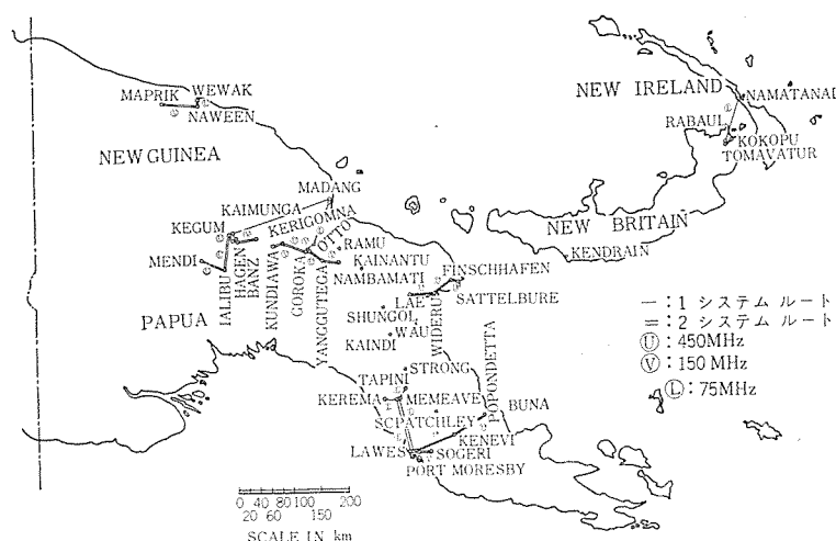
図 1.1 パプア・ニューギニア納入小容量多重回線 New communication circuit of T. P. N. G.
