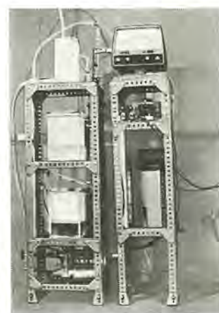
図 2.5 エジェクタによるオゾン処理実験装置 Apparatus for ozone treatment with ejector.
