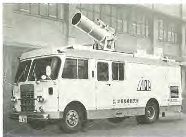
図2.1 レーザレーダ排煙観測車 Mobile Laser Radar for stack effluent monitoring.
