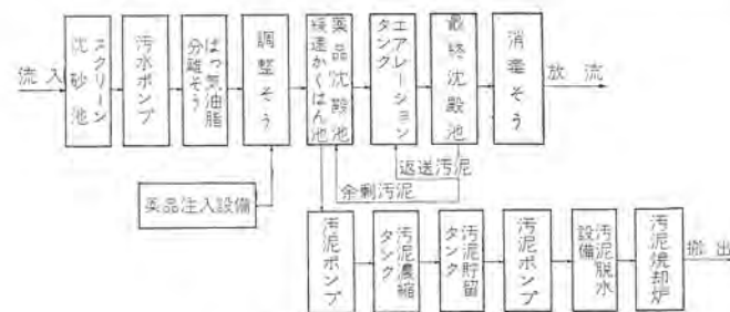
図4.1 工場排水処理場のプロセス Process of industrial waste water treatment plant.
