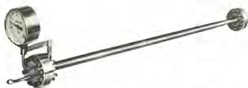
パイプ : ステンレス 30 mmφ×800 mL×1 mm ウィック : ステンレス 200 メッシュ 液体 : フレオン 2)
