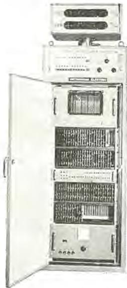
図 3.5 デジタルスピードドロー測定装置
