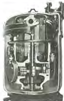
図 2.4 VD 形 圧縮機 Cutaway view of type VD Compressor.
