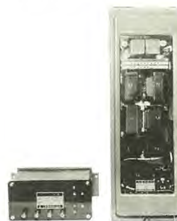
図 3.17 KKS-23 B-D き電線距離保護継電器 Type KKS-23 B-D distance relay.
