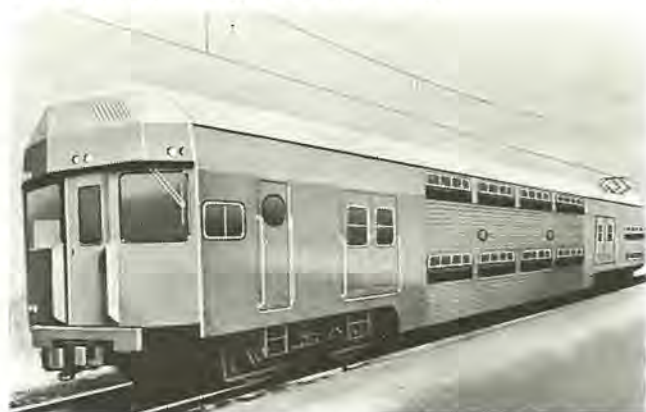
図 1. 1 オーストラリア N. S. W. G. R. 納め全2階建式直流電車 Double deck motor coach for N. S. W. G. R.
