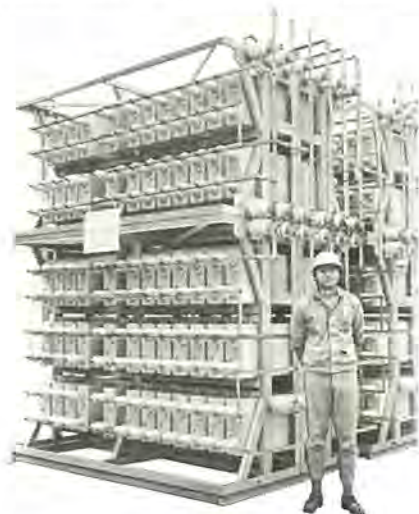
図 2.3 フィルムコンデンサ 14.8 kV 三相 50 Hz 26460 kVA. Film capacitors 14.8 kV 3 phase 50 Hz 26460 kVar rated.
