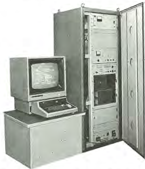
図 2.2 C 232 形 カラーキャラクタディスプレイ 制御部 (16 台用) Controller of type C 232 character display system.
