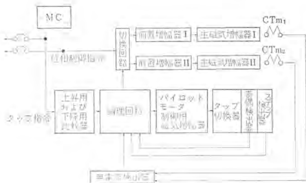
図 4.2 制御回路ブロック線図 Control circuit block diagram.
