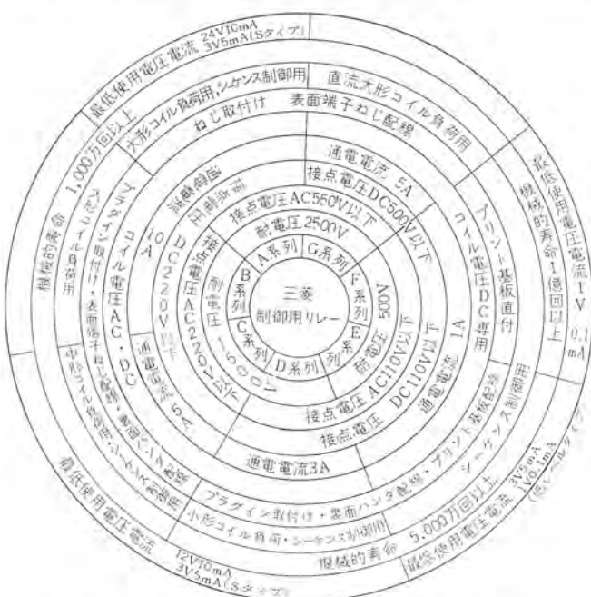
図 5.1 制御用電磁継電器の用途負荷からの選定表 Selection of magnetic control relay from uses and loads.
