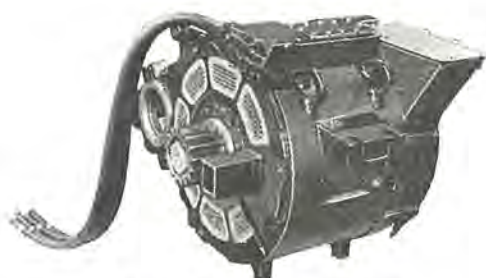
図 5.14 MT 52 A 形 主電動機 Type MT 52 A traction motor.
