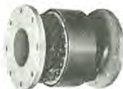
図 5. 1 試作した回転磁界形 2分の1波長板 Rotating field half wave plate constructed on trial.
