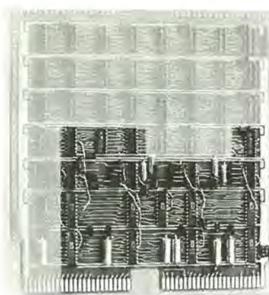
図 4.4 9ビット1024ワード MOS IC メモリ 基板 9 bits, 1024 words MOS IC memory card.
