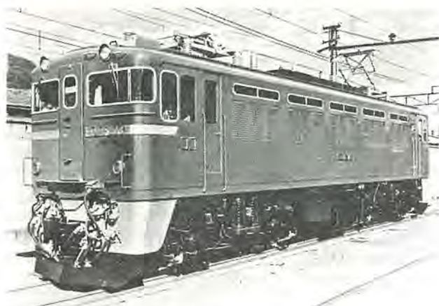
図 1.1 ED75700 形交流機関車 Type ED75700 AC electric locomotive.
