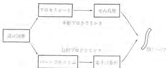
図 2.1 手動プログラミングと自動プログラミング Manual programming and computer programming.
