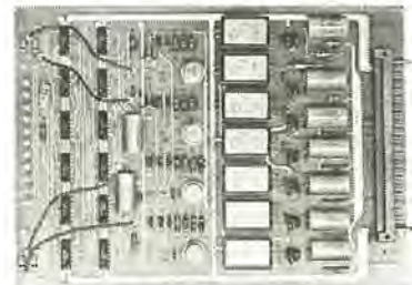
図 5.11 IC 式論理回路カード IC logic circuit card.
