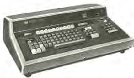
図 2.4 工業用キーボード Industrial type key board.
